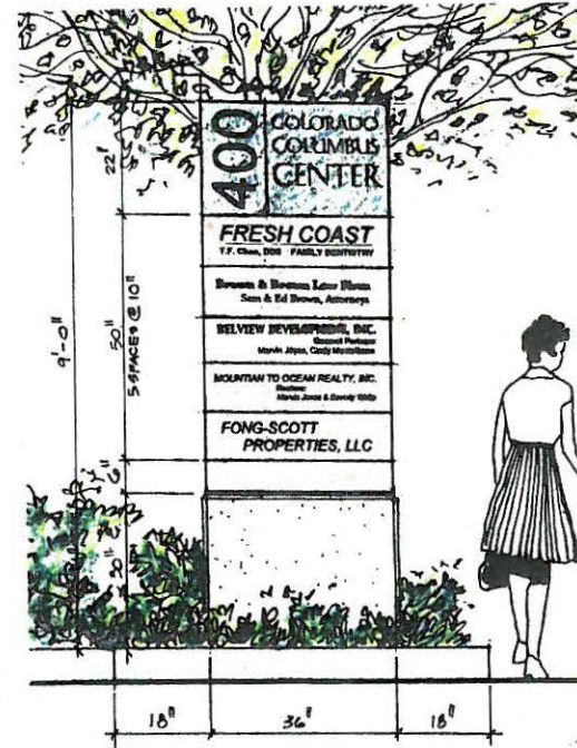
PYLON SIGN FACE ELEVATION Scale: 1" = 1'-0"
